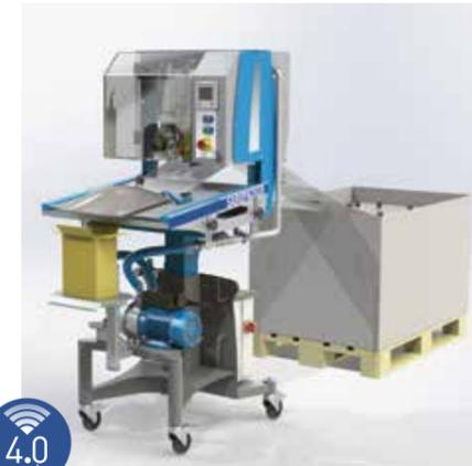
Remplisseuse semi-automatique flexible pouvant traiter des sachets individuels (Single) ainsi que des sachets en chaîne (Web). Elle est conçue pour remplir des sachets SAROBAGinBOX jusqu'à 20 litres et des sachets debout jusqu'à 5 litres (sachets debout possibles uniquement en mode Single). Elle convient à tous les types de produits alimentaires ou non alimentaires liquides et semi-liquides.
